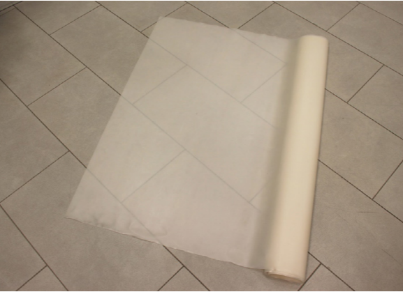
Figura 18: rolo de pele de silicone com o lado liso voltado para cima
