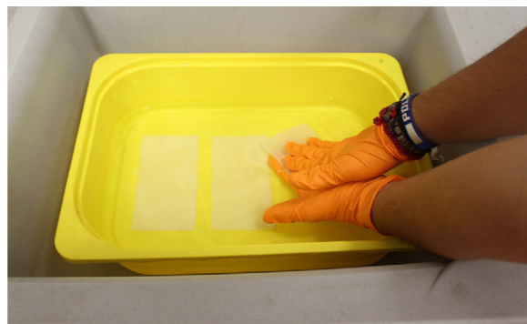
Figura 24: limpeza das películas de silicone
