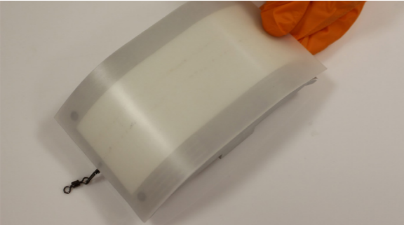
Figura 29: teste do pé com pele de silicone colada
