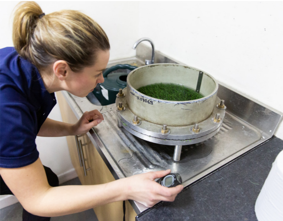
Figura 55: exemplo de aparelho para teste de porosidade
