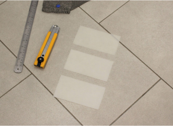
Figura 20:peles de silicone cortadas e prontas para serem limpas
