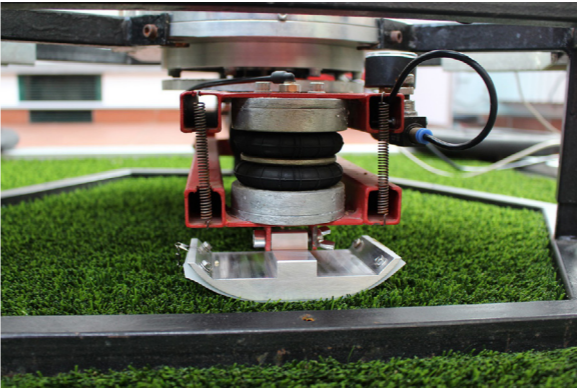
Figura 35: teste o pé na posição com a carga aplicada
