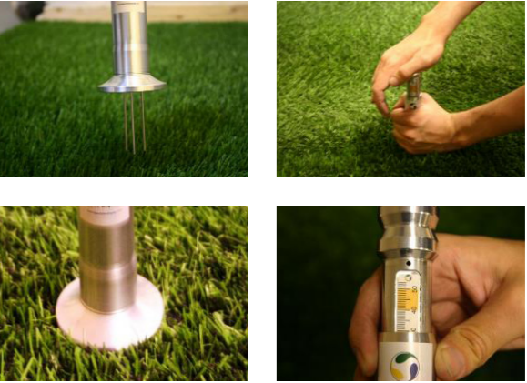
Figura 54: medidor de profundidade de preenchimento
