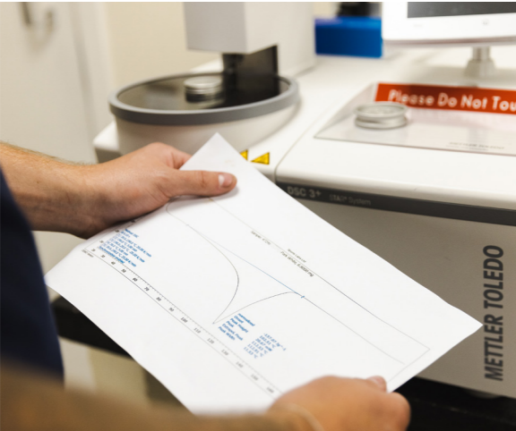
Figura 50: exemplo de curva DSC com pico de fusão único
