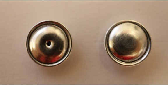
Figura 52: cadinho ventilado (esquerda) e cadinho não ventilado (direita)
